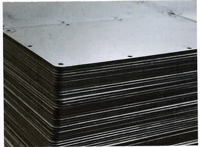
Um reproduzierbare Entgratergebnisse zu erzielen, muss man für das jeweilige Material die richtige Kombination von Drehzahl, Vorschub und Zustellung finden.
