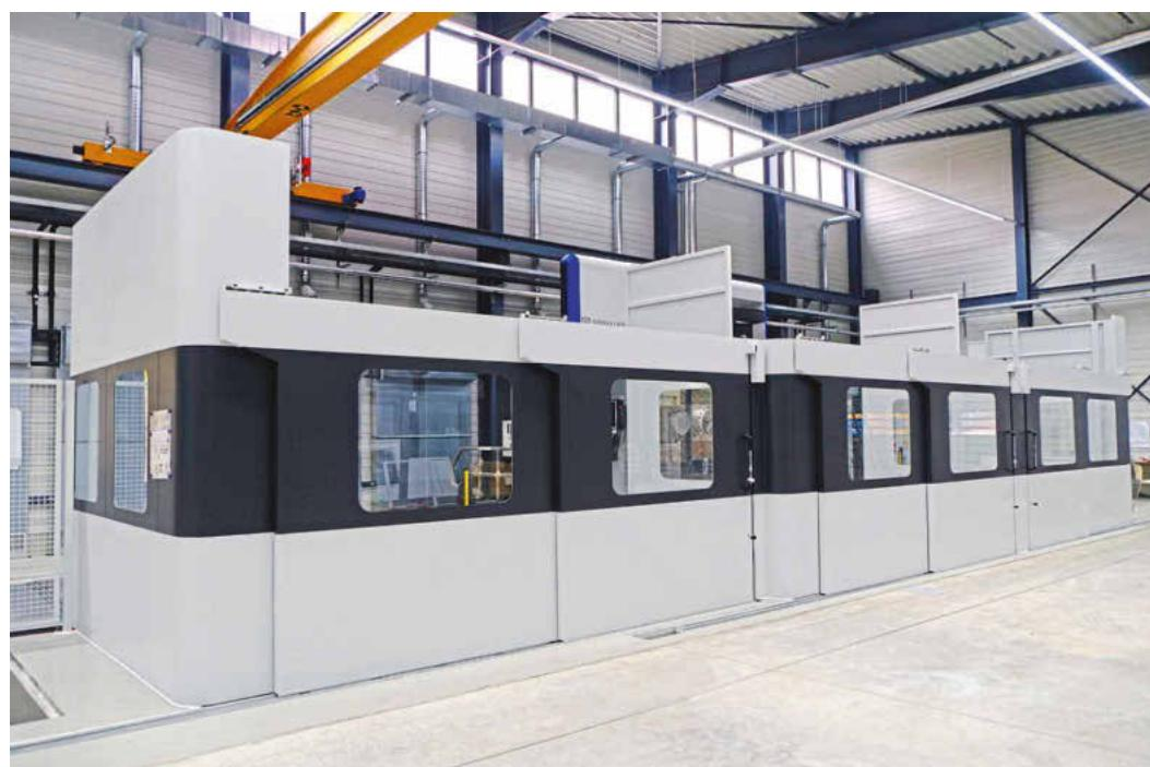
Auf der neuen Fahrständer-Fräsmaschine von Soraluce für die Großeilebearbeitung lassen sich Werkstücke bis 14 Meter Länge bearbeiten. Bild: H.P. Kaysser
